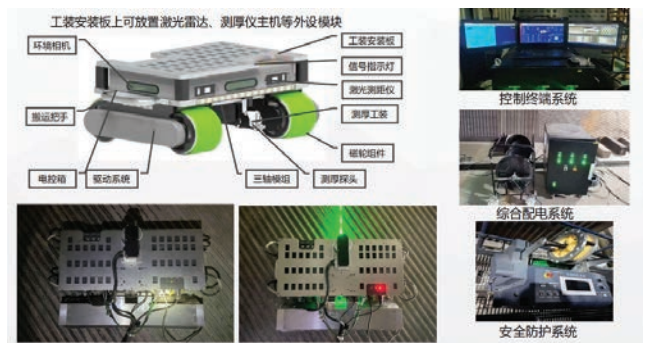
Hình 6. Thân chính của robot và hệ thống phụ trợ
