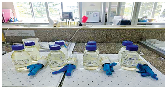
Hình 2: Mẫu dầu OLTC của các Trạm 110kV: Tân Biên 1 máy, Suối Dộp 2 máy, KCN Trảng Bàng sau khi đại tu bảo dưỡng thay dầu và sấy lọc.
