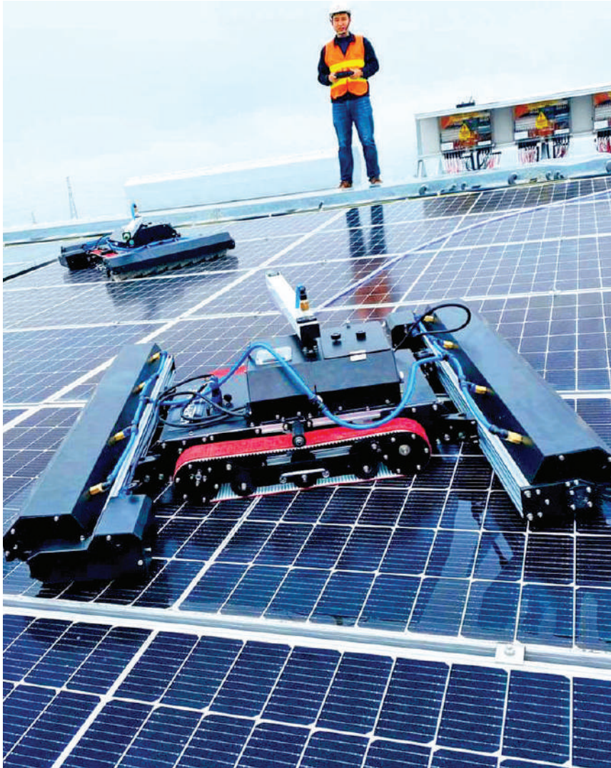
Một số đơn vị áp dụng Robot để vệ sinh những tấm pin năng lượng mặt trời, thay thế sức lao động thủ công của con người
