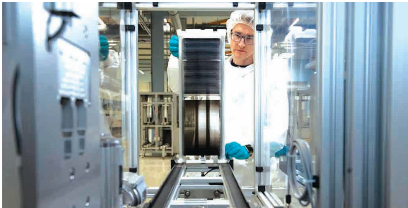
Nhà máy sản xuất Oxford PV ở Brandenburg, Đức, một nhánh của Đại học Oxford, tuyên bố hiệu suất 28% cho pin mặt trời tandem và cho biết họ đang phát triển một loại pin nhiều lớp với hiệu suất 37%. (Ảnh: Oxford PV)
