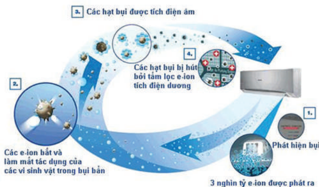
Hình ảnh mô phỏng quá trình lọc ion trong không khí
